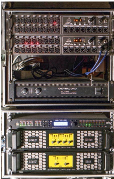
System nagłośnieniowy zasilany jest ze wzmacniaczy NAW HDQ10 i HD14, poprzez procesor DSP248E, także firmy NAW.
